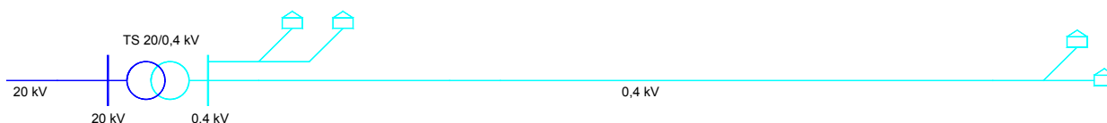
Slika 5. Primjer klasičnog prijenosa energije na 0,4 kV naponskoj razini (prikazan slučaj sa dugim NN vodom)
