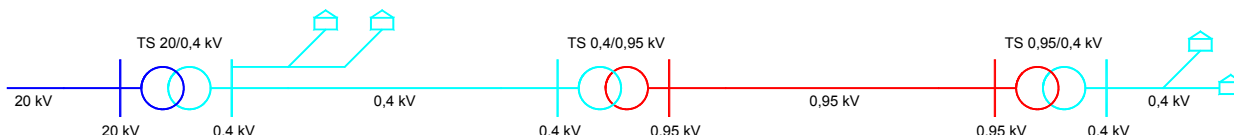
Slika 6. Primjer prijenosa energije na 0,95 kV naponskoj razini (implementacija TS 0,4/0,95 kV i TS 0,95/0,4 kV)
