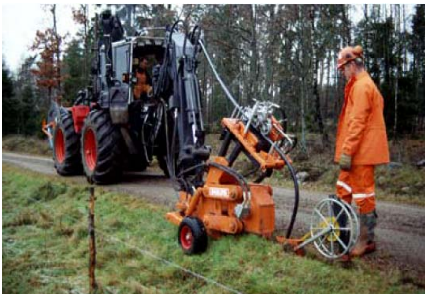
Slika 5. Pluženje s izravnim polaganjem kabela u zemlju
