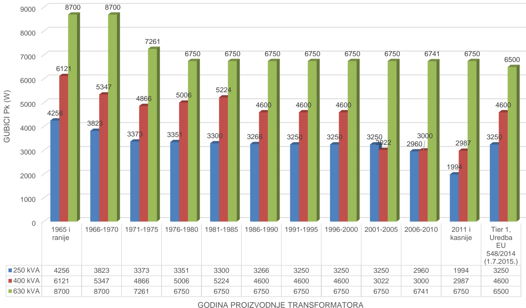
Slika 2.: Gubici kratkog spoja Pk (W) u ovisnosti o godini proizvodnje transformatora
