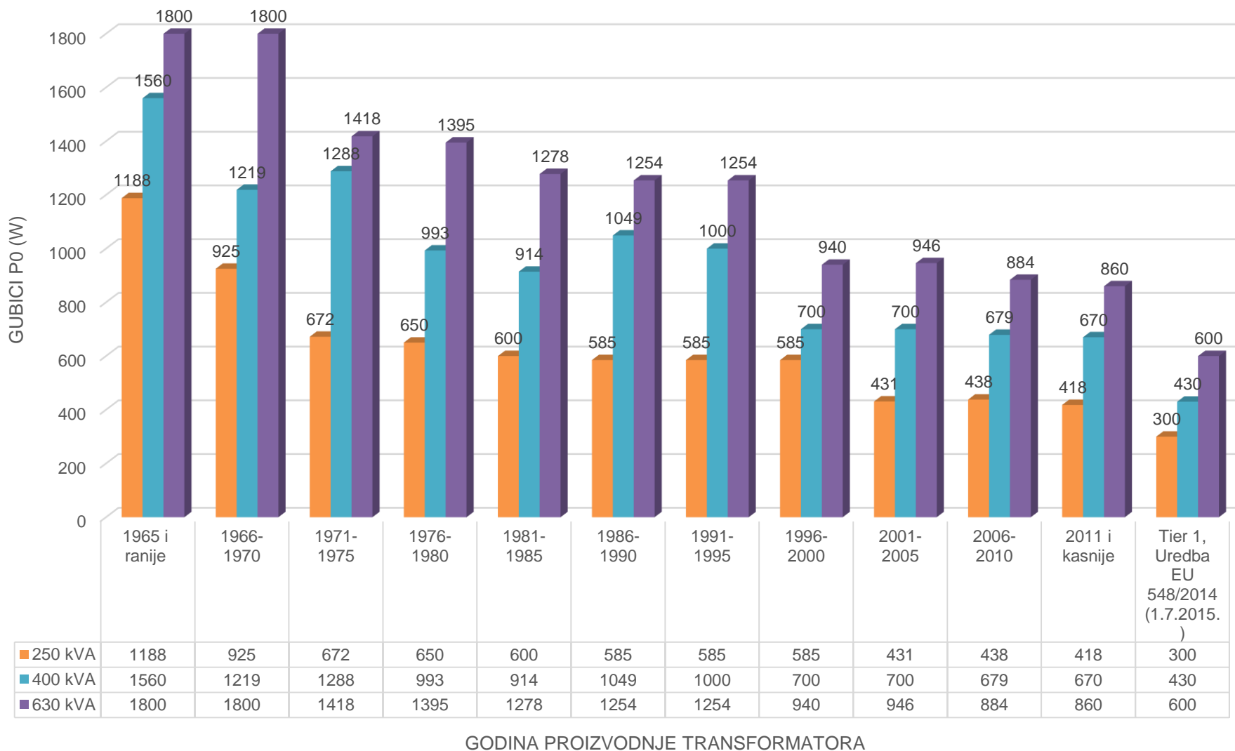
Slika 1.: Gubici praznog hoda P0 (W) u ovisnosti o godini proizvodnje transformatora
