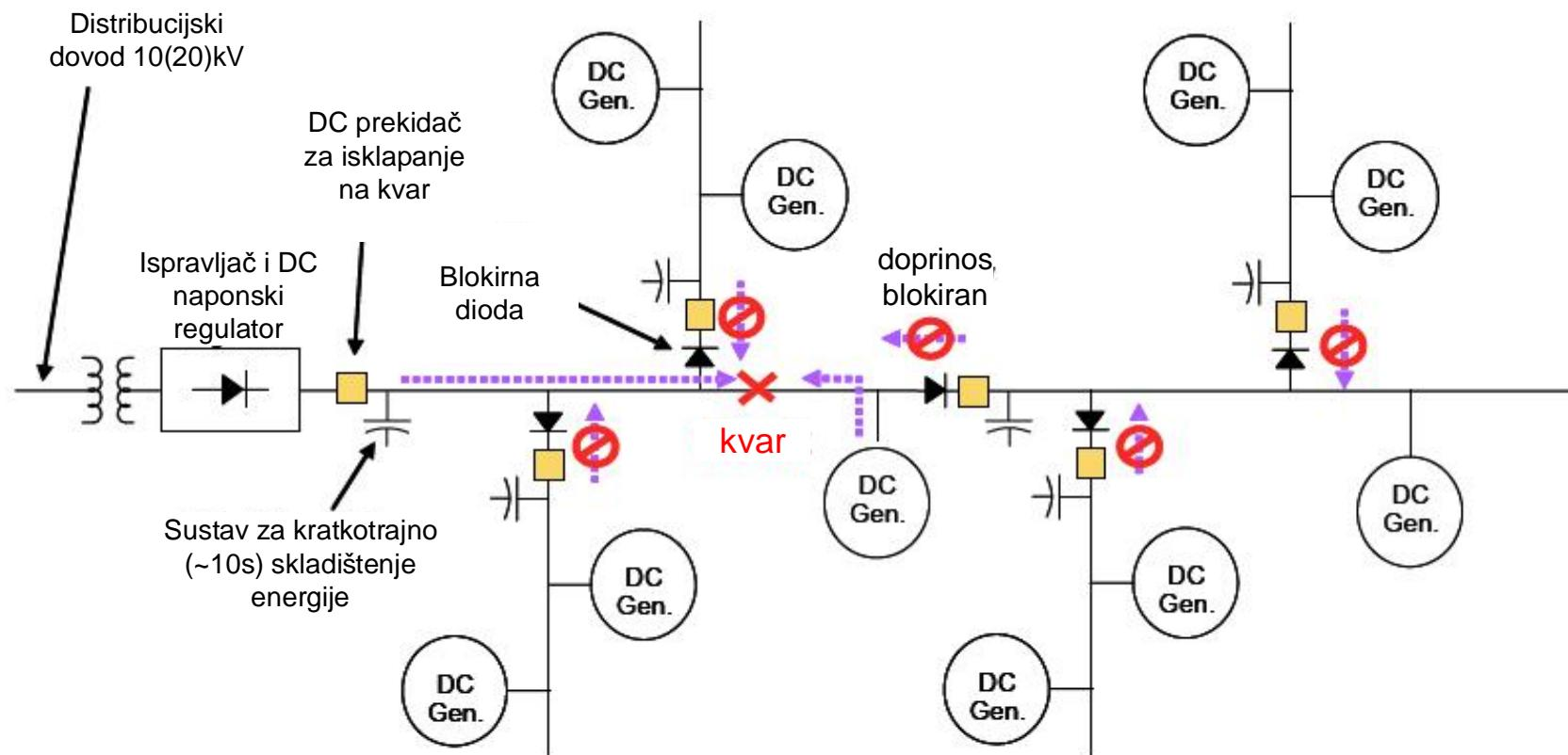
Zaštita mreže, proizvodnog postrojenja i proizvodne jedinice od kvarova i poremećaja
