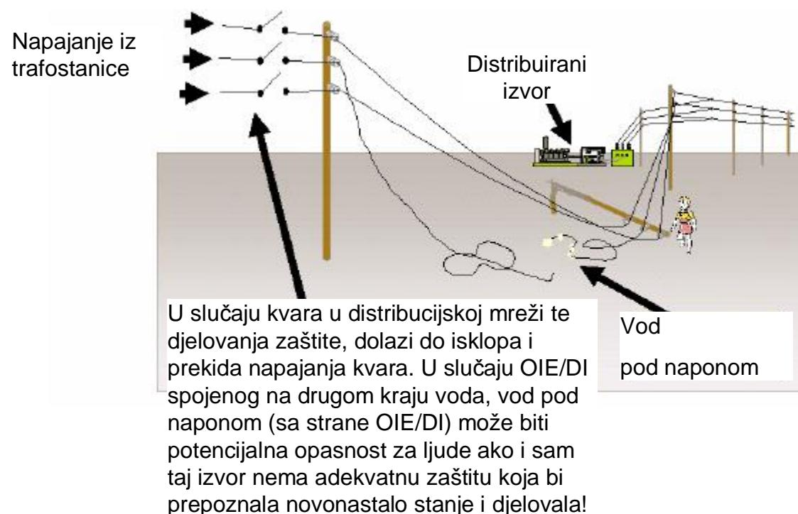
Primjer mogućeg doprinosa struji kvara na većoj naponskoj razini pri grupiranju OIE i DI kroz veći broj distributivnih stanica. Pri tom raspored i veličina OIE i DI ima utjecaja i na shemu reljene zaštite, a povećava se rizik pojave otočnog pogona i prenapona uslijed zemnih spojeva.
