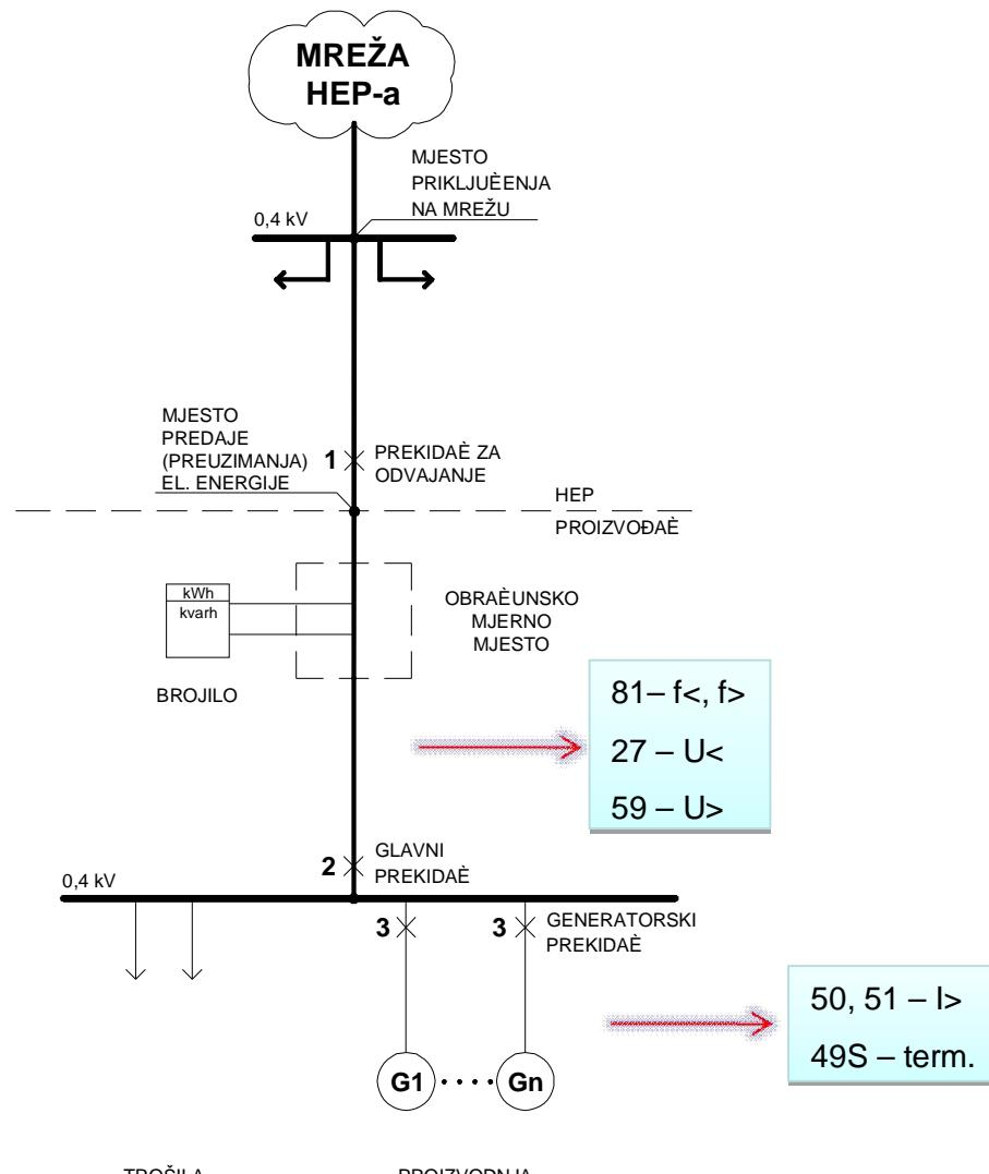
Zaštita mreže, proizvodnog postrojenja i proizvodne jedinice od kvarova i poremećaja
