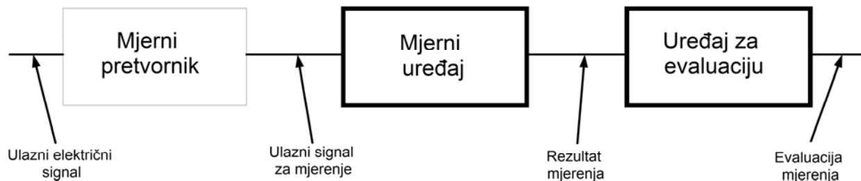
Slika 1 Mjerni kanal kako ga definira IEC 61000-4-30
