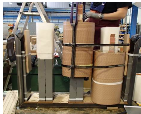
Slika 5. Montaža trostupnog i peterostupnog amornog transformatora
