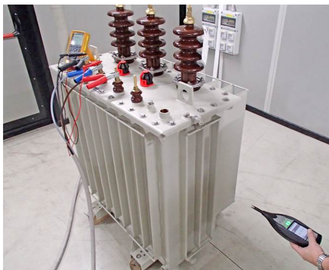
Slika 6. Ispitivanje amorfnih transformatora u ispitnoj stanici i gluhoj komori
