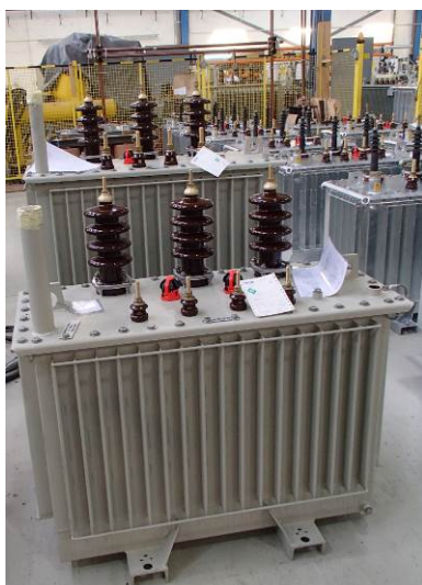
Slika 6. Ispitivanje amorfnih transformatora u ispitnoj stanici i gluhoj komori
