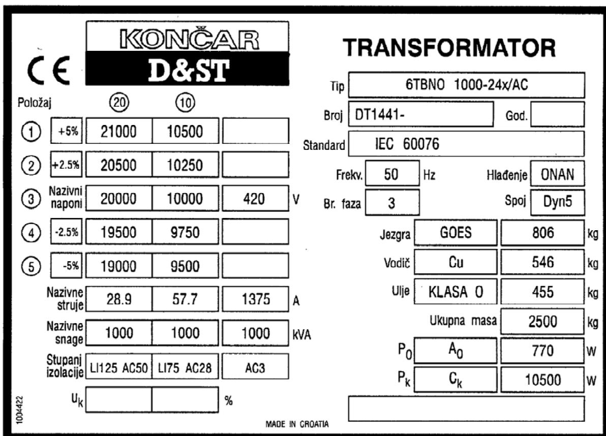
Slika 1. Primjer natpisne pločice prema normi HRN EN 50588-1:2015
