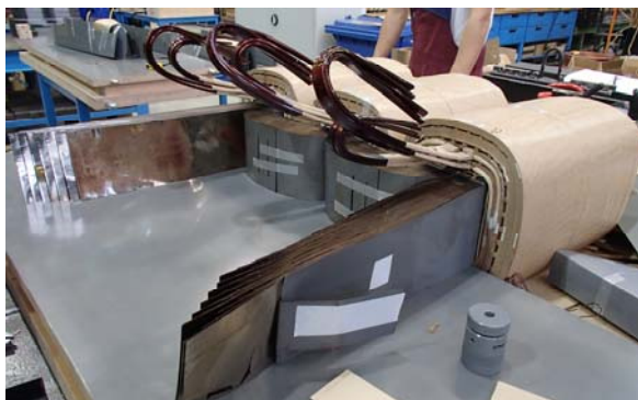
Slika 5. Montaža trostupnog i peterostupnog amornog transformatora
